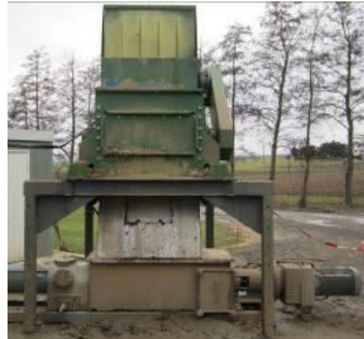
Abbildung 12: Zerreißer mit hohem Durchsatz und direkt angeschlossener Pumpe, allerdings steinempfindlich, Foto: KWS
