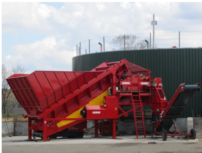
Abbildung 10: BeetBeater von Grimme – „ein Rübenfeststoffdosier“, Foto: KWS
