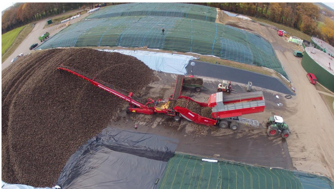
Abbildung 19: Einlagerung mit dem BeetLoader-System von Grimme, Foto: KWS
