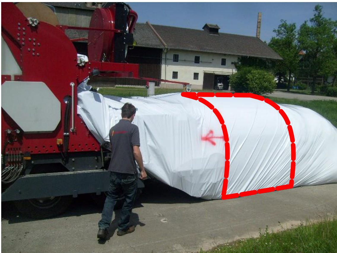
Abbildung 1: Pressvorgang beim Folientunnel, rot markiert der Bereich des Metalltunnels
