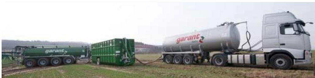
Ein zwischengeschalteter Container dient als Puffer zwischen Transport- und Verteilfahrzeug. Die beiden Fahrzeuge sind dadurch zeitlich nicht so stark abhängig, Standzeiten können dadurch stark reduziert werden.
