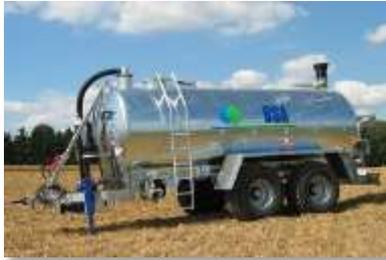
Ausgestattet mit einem Ansaugdom für das Ausbringfahrzeug kann jeder Schlepper oder Agrar-LKW als Zugfahrzeug verwendet werden. Die Bereifung braucht keine Agrar-Bereifung darzustellen, muss aber auf Geschwindigkeit und Gewicht des Zuges abgestimmt sein.
