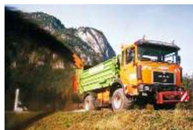
Verfahren: Die Transporteinheiten (Schlepper mit Streuer bzw. LKW) übernehmen das Transportgut an der Anlage, transportieren es bis zum Feld und bringen es unmittelbar aus.
