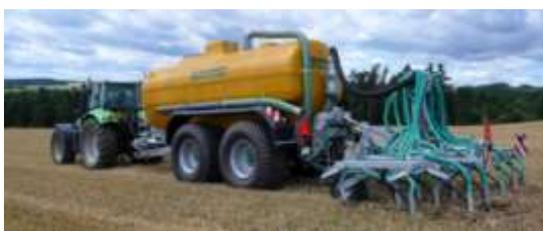
Diese Verteilwagen dienen ausschließlich der Übernahme des Flüssigdüngers am Feldrand und dessen Verteilung mit diversen Verteilern (nach DüVO), Ausführungen sind i. d. R. 2- oder 3-Achsfahrzeuge.
