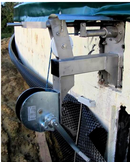
Abbildung 2: Seilzug und Schwenkeinrichtung an der Führungsstange eines Tauchmotorrührwerks
