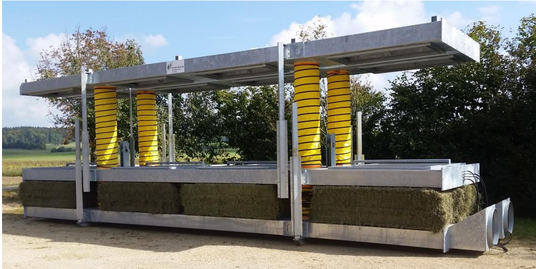
Abbildung 2: Belüftungssystem für Quaderballen der Firma Henkel (auch für Rundballen verfügbar) mittels Kraft-Wärme-Kopplung über ein biogasbetriebenes BHKW (Bildquelle: S. Henkel, Henkel)
