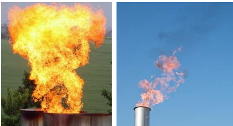
Abb. 2: Offene Gasfackel – rußende Flamme bzw. Rauch durch unvollständige Verbrennung
