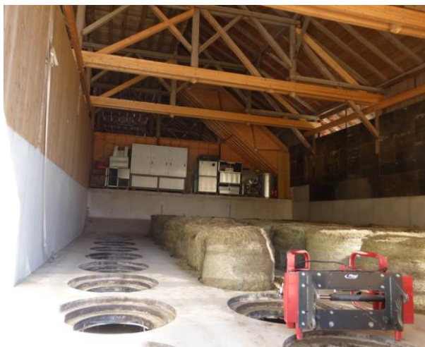
KWK-Nutzung Rundballenanlage auch für Lohn-trocknung (5 Reihen à 9 Auslässe) Besonderheit: selbstzentrierende Auslässe für Ballendurchmesser 120 und 150 cm vorne rechts: Ballenzange (Quelle: LfL, ILT 1b, S. Jakschitz-Wild, 2015)
