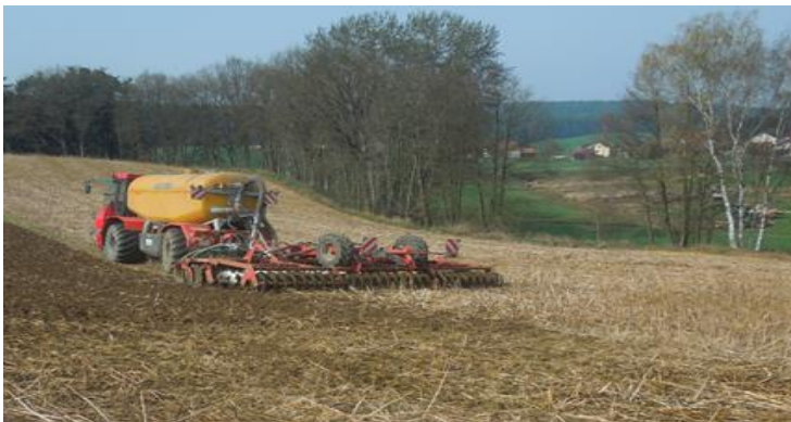
Güledüngung auf Stoppel (Injektionsverfahren) mit Selbstfahrer
