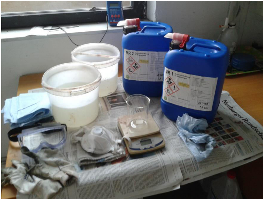
Abb. 13: Beispiel für die unzureichende Beachtung von Schutzmaßnahmen bei der Dosierung von Gefahrstoffen; Bild: © L. Großhauser
