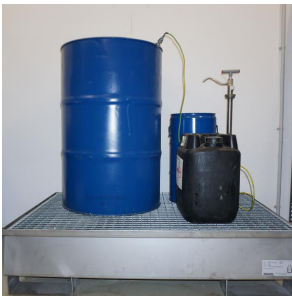
Abb. 4: Ordnungsgemäße Lagerung flüssiger Gefahrstoffe, Bild: © G. Henkelmann, LfL-AQU
