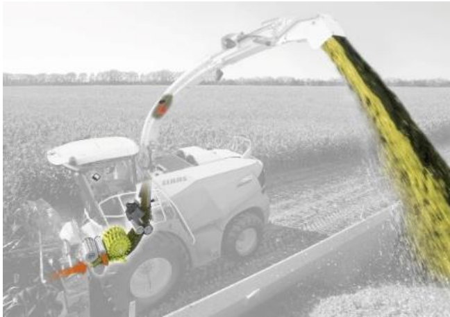
Abbildung 5: Verrechnung der Daten aus Volumenstrom und Trockensubstanz als Grundlage der Ertragsmessung.
