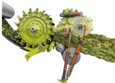
Abbildung 3.: Volumenstrommessung im Feldhäcksler durch Erfassen der Einzugsgeschwindigkeit und Messen der Position der Vorpresswalzen.
