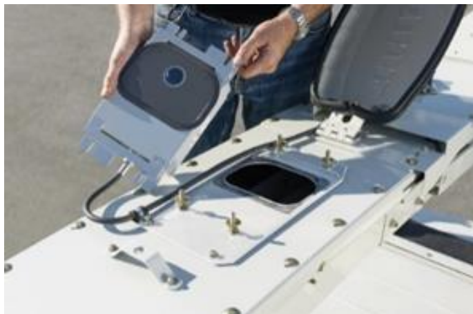
Abbildung 4: Nah-Infrarot Sensor auf dem Auswurfkrümmer des Feldhäckslers ermittelt durch reflektierende Lichtwellen den Trockensubstanzgehalt und künftig Inhaltsstoffe.
