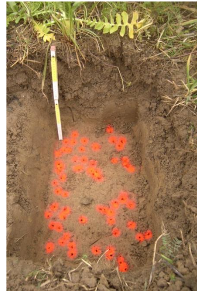
Abb. 13: Jeder rote Punkt ist eine Regenwurmröhre. Viele Röhren in 45 cm Tiefe deuten auf eine optimale und durchlässige Tragschicht im Bereich von 30 bis 45 cm Tiefe hin.
