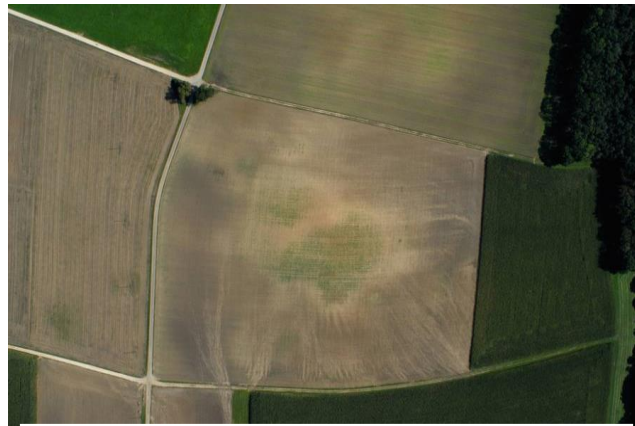
Abb. 4: Schleichende Erosion: dunkle Stellen: Humus und Schluff wurden hangabwärts verlagert; helle Stellen: Krume abgetragen, der nährstoffarme, hier kiesige Unterboden kommt zum Vorschein
