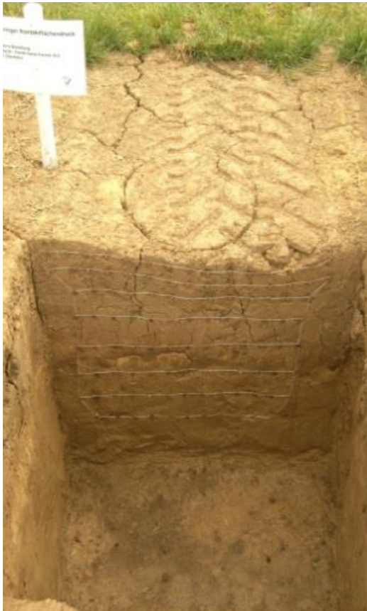
Abb. 9: Breitere Reifen führen zu geringerem Kontaktflächendruck und zu weniger tiefen Spuren
