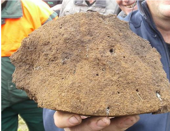
Abb. 7: Optimale Ausprägung der Tragschicht; viele Regenwurmröhren und Wurzelgänge; sehr viele feine und mittlere Poren
