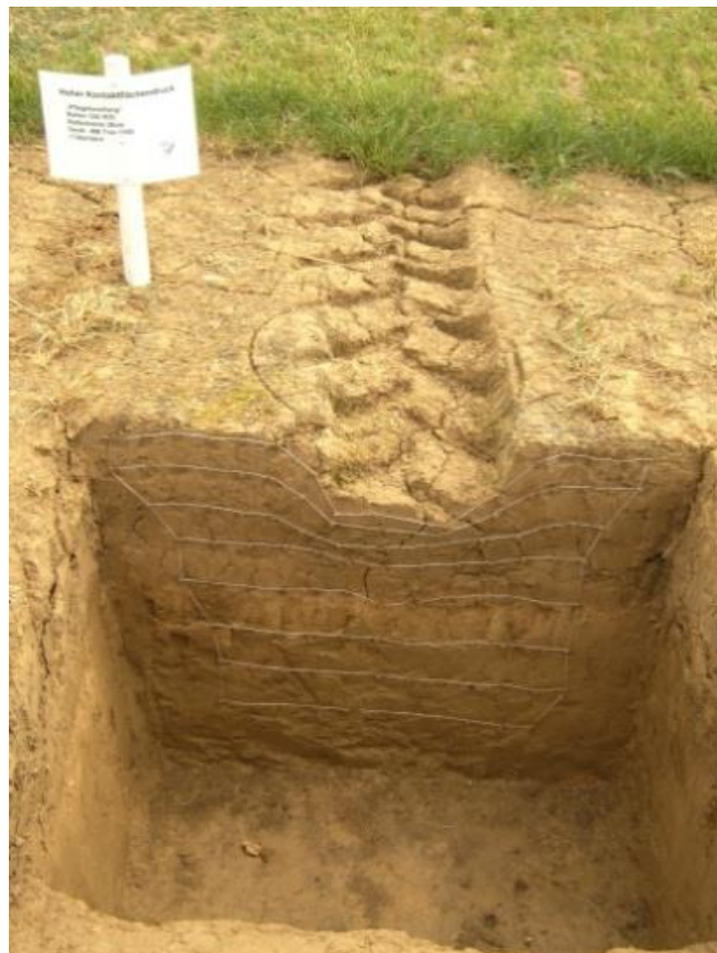
Abb. 10: Schmale Reifen, hohe Radlast und damit hoher Kontaktflächendruck führen zu tiefen Spuren im Acker
