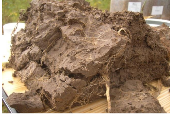
Abb. 2: Stark verdichteter Boden infolge von Befahren im nassen Zustand; keine Krümel sondern kantiges Polyedergefüge; Wurzeln nur in den Klüften zwischen den Polyedern; stark eingeschränktes Wurzelwachstum; stark verminderte Wasserspeicherfähigkeit und -aufnahmefähigkeit
