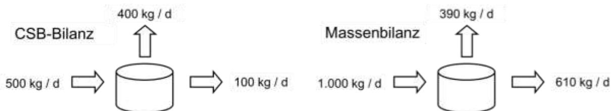
**Abbildung 2:** CSB-Bilanz (links) und Massenbilanz (rechts) der Modellbiogasanlage bei der Vergärung von Grassilage
