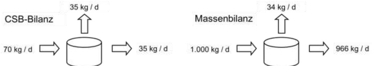
**Abbildung 1:** CSB-Bilanz (links) und Massenbilanz (rechts) der Modellbiogasanlage bei der Vergärung von Rindergülle
