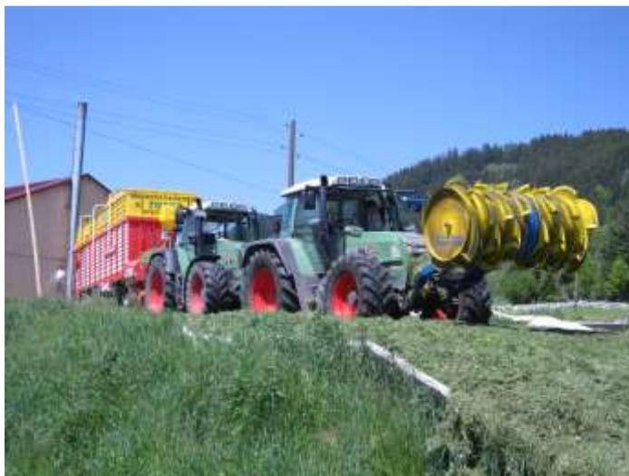
Abbildung 5: Bei der Verdichtung im Silo sind gleichmäßige, dünne Schichten erforderlich, die z.B. mit einem Ladewagen oder auch einem Siloverteiler erzeugt werden können
