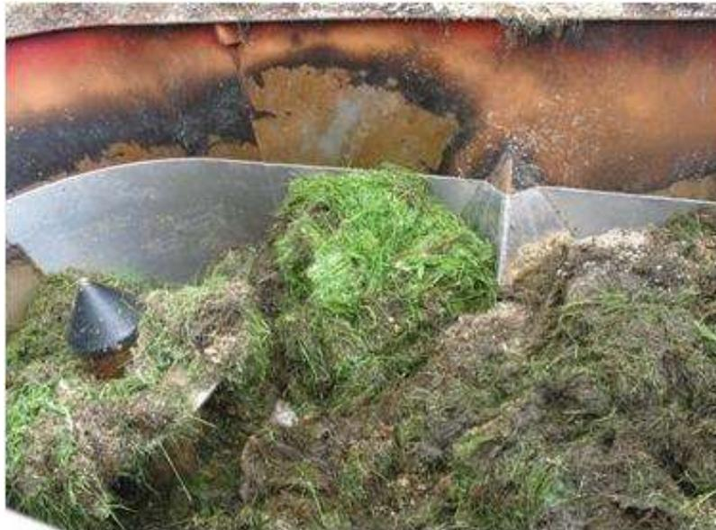
Abbildung 1: Grassilage und Grünschnitt im Feststoffeintrag einer Biogasanlage
