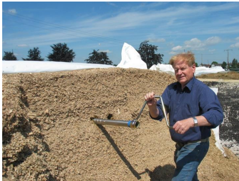
Abbildung 2: Dichtebestimmung mittels speziellem Handbohrer, „Pioneer – Probenbohrer“ (Foto Rößl)
