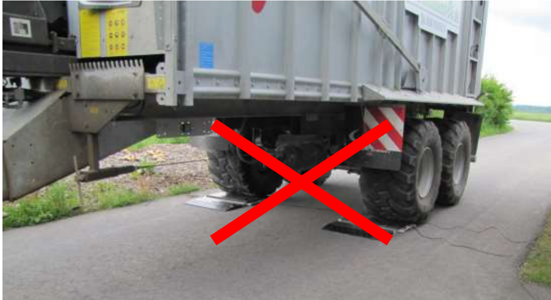
Abbildung 3: Achsweises Wägen (hier mit Radlastwaagen) ist nicht für Abrechnungszwecke erlaubt
