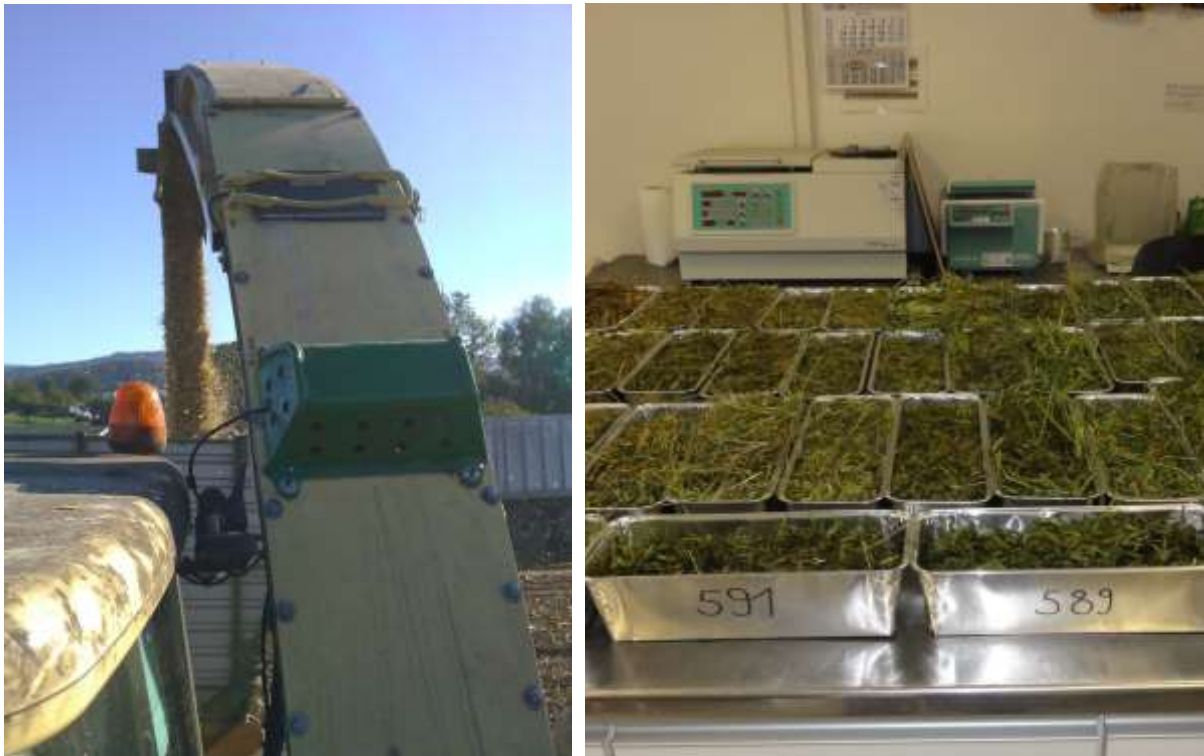
Abbildung 7: Online-Feuchtebestimmung am Auswurfkrümmer eines Feldhäckslers mittels NIRS (links) und Graswelkproben für die Trockenmassegehaltsbestimmung im Labor (rechts)
