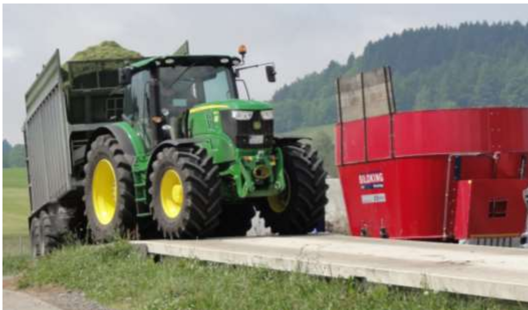
Abbildung 1: Eine geeichte Fuhrwerkswaage ist die Grundvoraussetzung für eine mengenmäßige Abrechnung von Substratlieferungen
