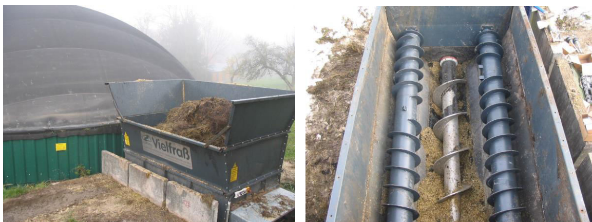
Abb. 14/15: Robuste Fütterungstechnik: Einbringung über 2 auflösende und 1 Stopfschnecke; Fotos: N. Marschall, Ravensburg
