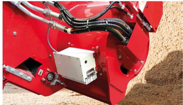
**Bild 14:** NIR-System vorn im Fräskopf (Quelle: Fa. SILOKING)
