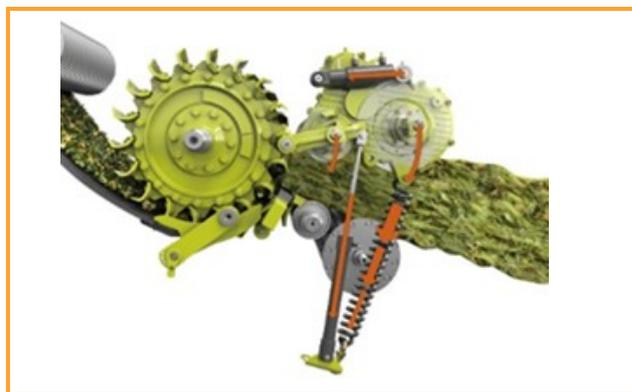
**Bild 5:** Volumenstrommessung im Feldhäcksler durch Erfassen der Einzugsgeschwindigkeit und Messen der Position der Vorpresswalzen. (Quelle: Fa. Claas)
