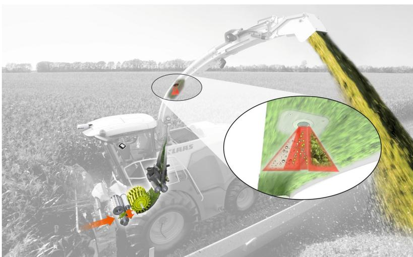
**Bild 7:** Verrechnung der Daten aus Volumenstrom und Trockenmassegehalt als Grundlage der Ertragsmessung. (Quelle: Fa. Claas)
