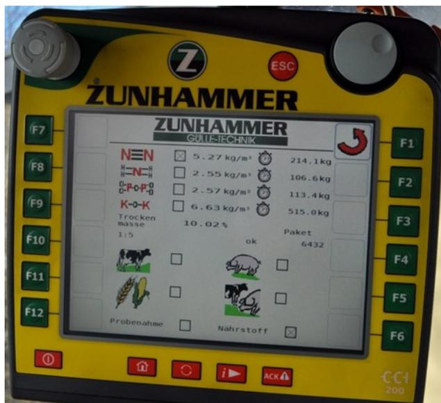
Bild 10: Messwert-Übersicht (Quelle: Fa. Zunhammer)
