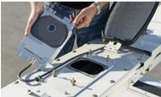
**Bild 6:** Nah-Infrarot Sensor auf dem Auswurfkrümmer des Feldhäckslers ermittelt durch reflektierende Lichtwellen den Trockenmassegehalt und künftig Inhaltsstoffe. (Quelle: Fa. Claas)
