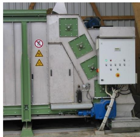
Abb. 12 und 13: Feststoffvorlagebehälter mit Auflöse- bzw. Mischwalzen (Fotos: LfL)
