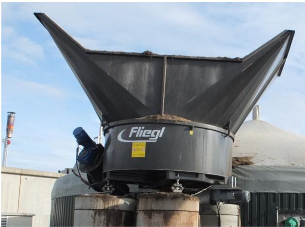
Abb. 9: Rundcontainer mit Austragsschwert (Foto: LfL)
