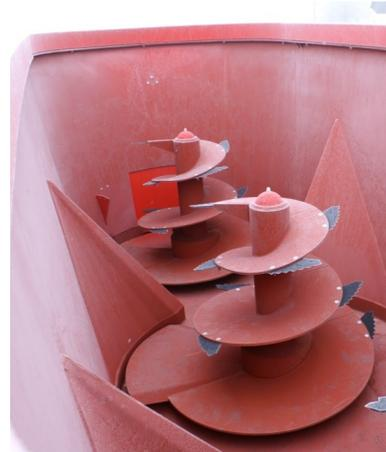
Abb. 10 und 11: Vorlagebehälter mit stehenden Intensiv-Mischschnecken (Fotos: LfL)
