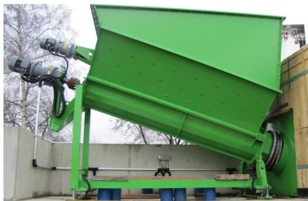
Abb. 3: Trichter mit Schneckeneintrag (Foto: LfL)
