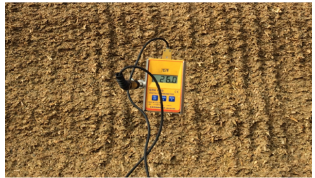
Bild 7: Temperaturbestimmung mittels Messsonde (Quelle: Misthilger LfL)
