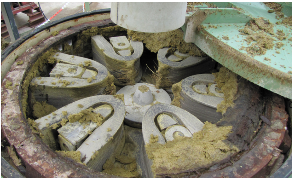
Bild 2: Hammermühle (Quelle: Kissel, LfL)
