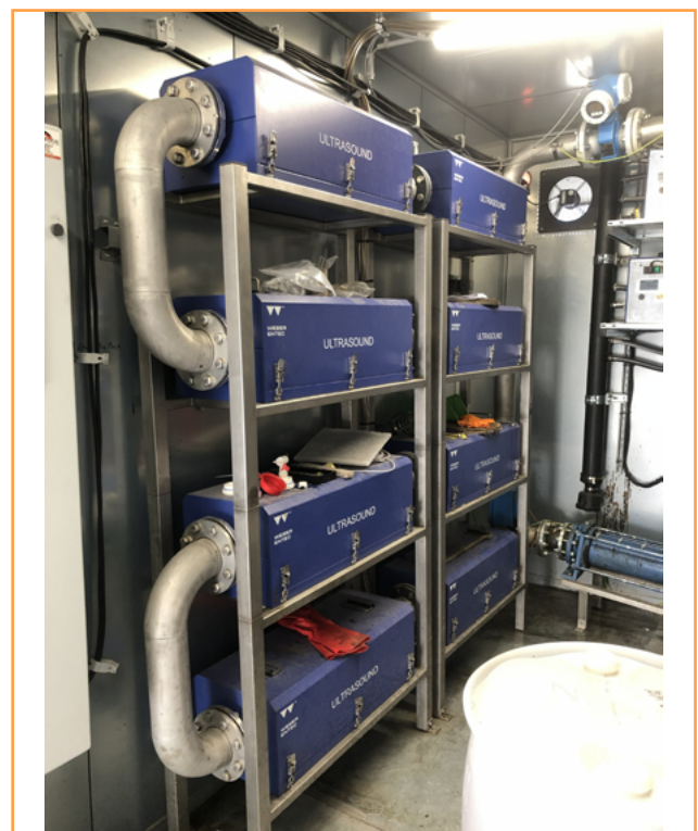
Bild 12: Ultraschall-Rohrreaktor zur Beschallung von Biogassubstrat (Quelle: Rainer Kissel, LfL)
