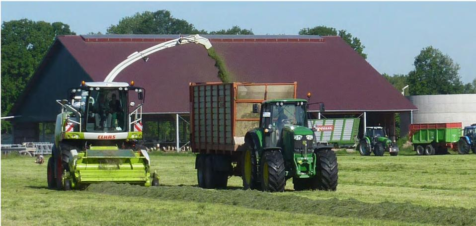
**Abb. 1:** In vielen Fällen wird beim 1-phasigen Verfahren das traditionelle Schlepper-Gespann mit dem Häcksel-Transportwagen verwendet.
