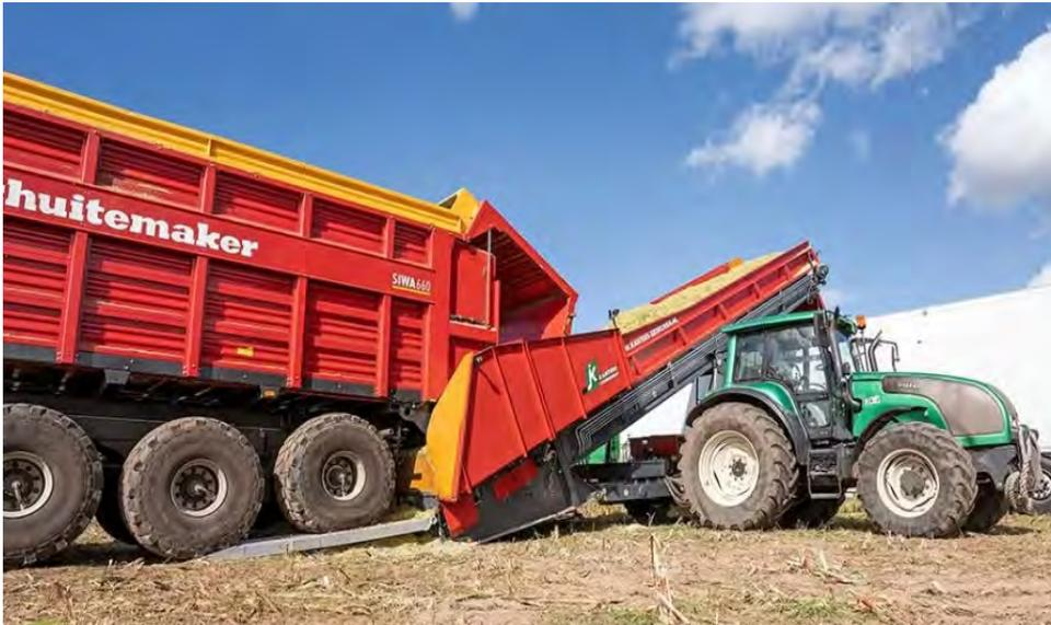
**Abb. 4:** Beim 3-phasigen Verfahren wird neben dem Feldtransport dann das Erntegut mittels Überladeband / -station auf ein Straßentransportsystem z.B. den LKW übergeladen.
