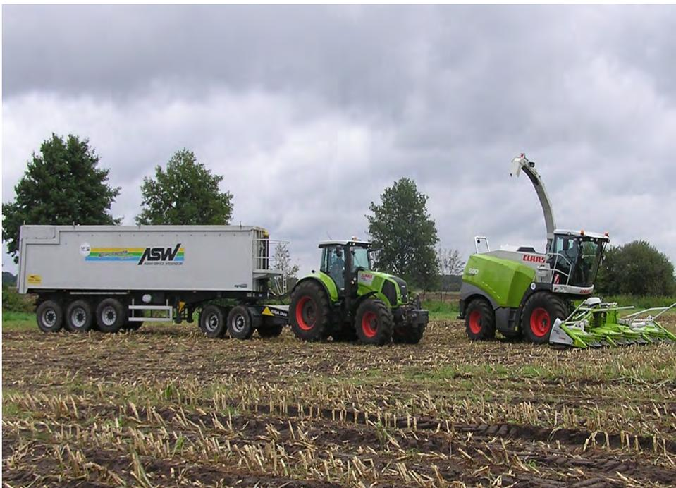
**Abb. 3:** Im 1-phasigen Verfahren kann die Schlagkraft in ebenen Bedingungen mit dem Dolly-Auflieger erhöht werden.
