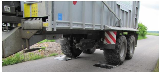
**Bild 3:** Achsweises Wägen (hier mit Radlastwaagen) ist nicht für Abrechnungszwecke erlaubt (Bildquelle: LfL)
