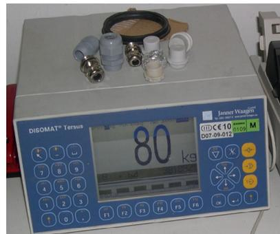
**Bild 4:** Waagenterminal mit integriertem Datenspeicher (Bildquelle: LfL)
