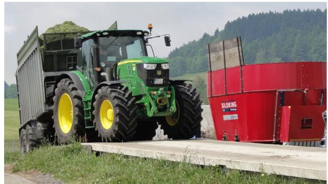
**Bild 1:** Eine geeichte Fuhrwerkswaage ist die Grundvoraussetzung für eine mengenmäßige Abrechnung von Substratlieferungen (Bildquelle: LfL)
