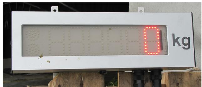
**Bild 2:** Bei Benutzung einer Fernbedienung für die Fuhrwerkswaage muss der Fahrer die Waagenbrücke und die Anzeige der Waage vom Fahrzeug aus einsehen können (Bildquelle: LfL)
