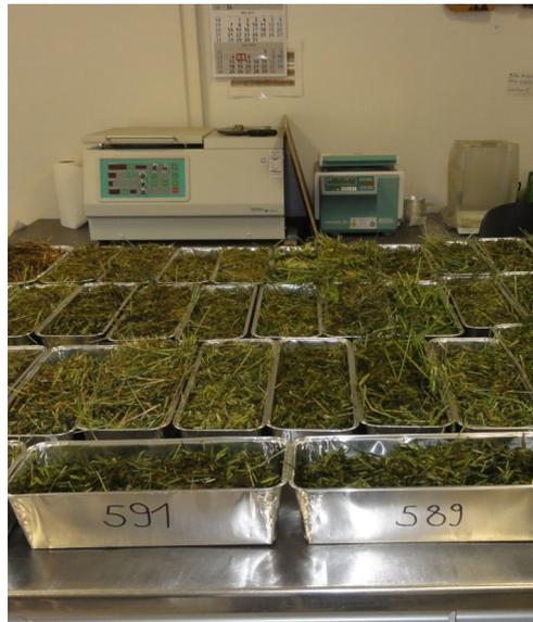
**Bild 6a,b:** Online-Feuchtebestimmung am Auswurfkrümmer eines Feldhäckslers mittels NIRS (links) und Grasanwelkproben für die Trockenmassegehaltsbestimmung im Labor (rechts) (Bildquelle: LfL)
