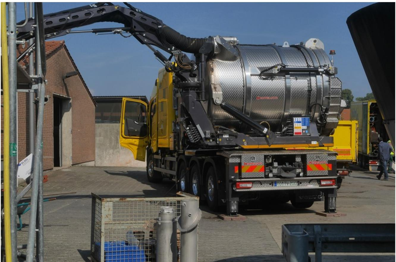
**Abb. 1:** Der Einsatz mobiler Hochleistungssauggeräte zur Entfernung der Ablagerungen im Gärbehälter erleichtert die Arbeit und minimiert die Entstehung von gefährlichen Gasen (Quelle: LLH).
