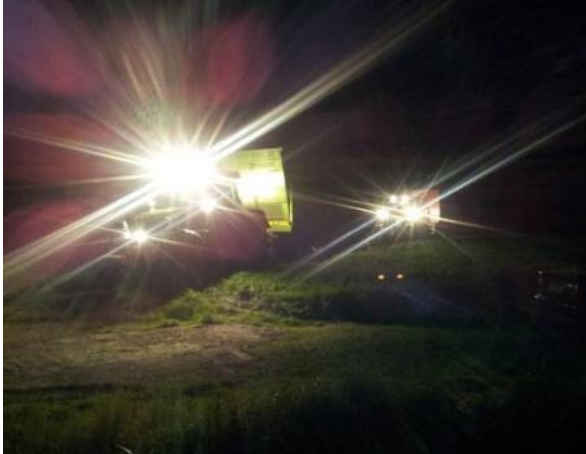
Abb. 35: Risiko durch Blendern mit Arbeitsscheinwerfern und im Schatten liegende Gefahrenbereiche
