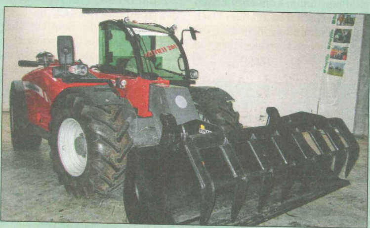
Die MF-9000er-Teleskopladerbaureihe umfasst vier Modelle: Die max. Hubhöhen reichen von 5,20 bis 7,00 m, bei max. Hubkräften von 2,2 bis 3,5 t. Die Motoren leisten je nach Modell 75, 100 oder 130 PS.
