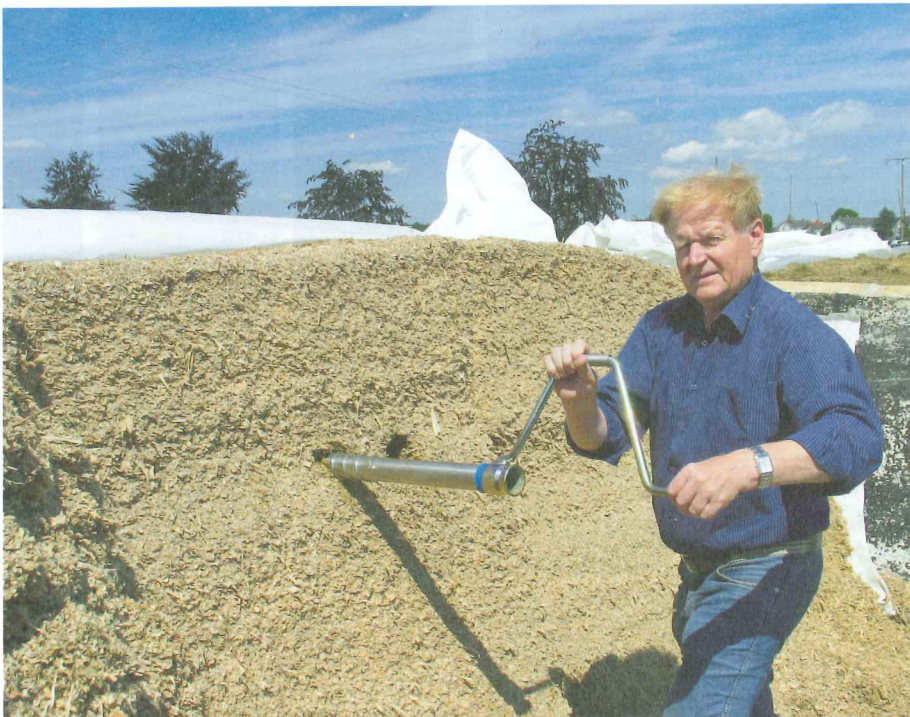
Dichtebestimmung mittels speziellem Handbohrer, „Pioneer – Probenbohrer“.
