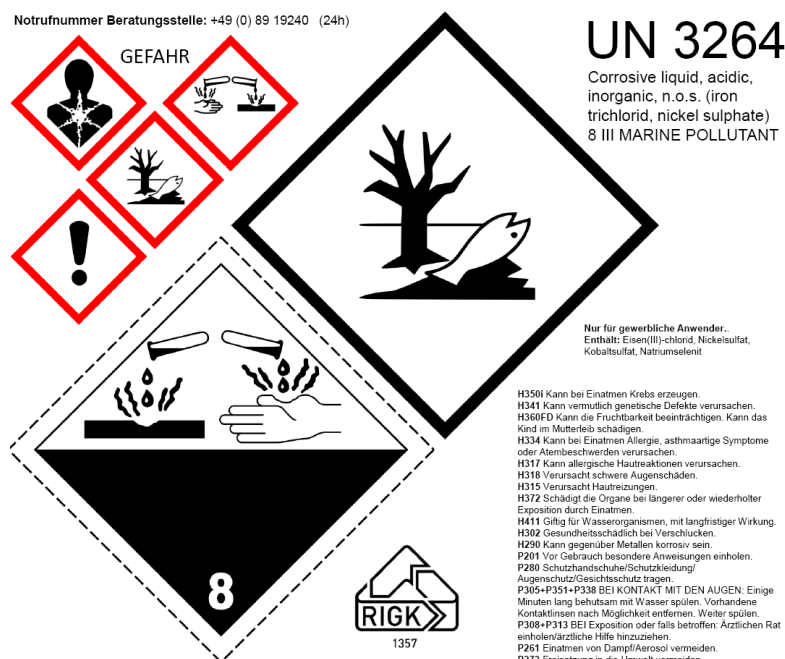
Abbildung 5: Beispiel für eine GHS-Kennzeichnung bei einem flüssigen Spurenelementprodukt, zusätzlich ADR-Symbole für den Transport (Quelle: atres, 2017)
