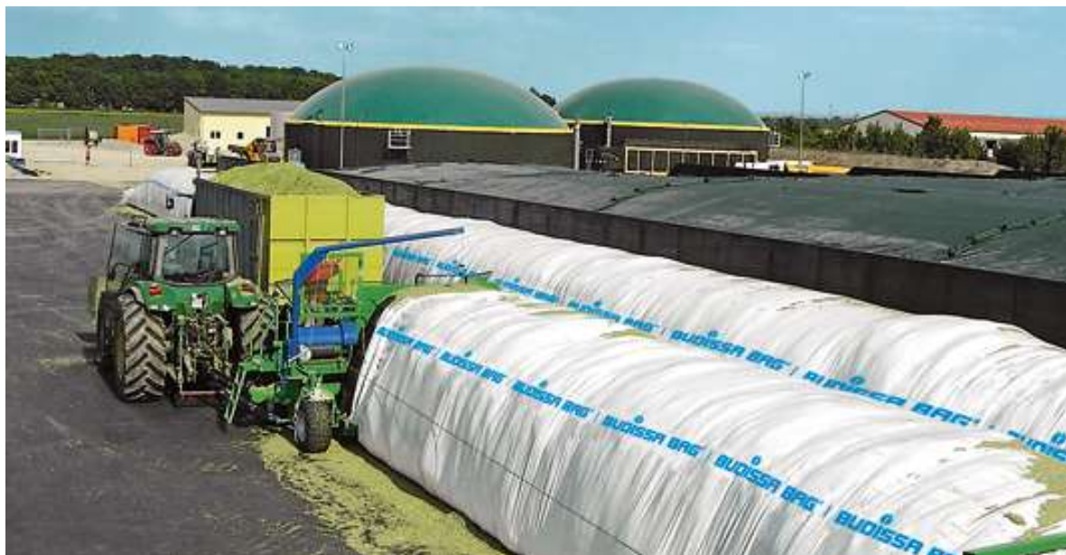
Abbildung 2: Einsatz einer Siloschlauchpresse mit Rotor
